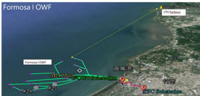
海洋風場位於竹南外海二至五公里處，如上圖所示。已完工並運轉之風機如上圖所示(#21, #28)，風場上方之海氣象觀測塔如圖菱形所標示。
